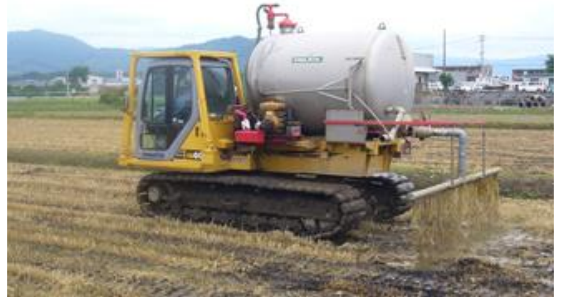
車体上部旋回タイプの散布車 (山鹿市バイオマスセンター：岩下幸司撮影)
